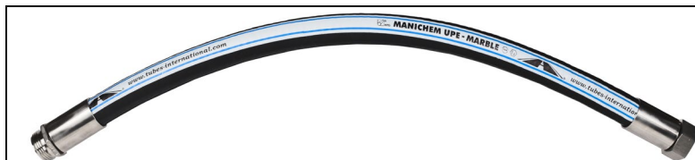
Wąż MANICHEM MARBLE DN19 z końcówkami ze stali nierdzewnej AISI 316 (GD-VSLB-025-019-SS, GD-MSLB-025-019-SS) z gwintem BSP 1" zewnętrznym i wewnętrznym, zaciśniętymi tuleją ze stali nierdzewnej AISI 304 (TI-LR-033-12-SS).
