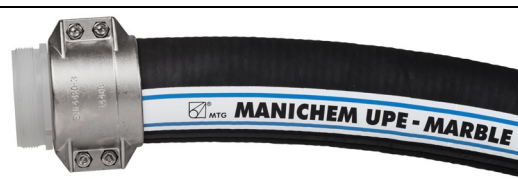
Wąż MANICHEM MARBLE DN75 z końcówką z gwintem zewnętrznym 3" BSP wykonaną z polipropylenu zamontowaną obejmą skorupową ze stali nierdzewnej TI-SC-075-080-SS.
