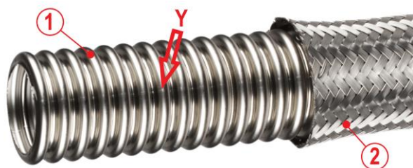
Konstrukcja typowego węża metalowego: 1 – karbowana tuba węża; Y – wzdłużny spaw tuby węża (wykonany przed karbowaniem); 2 – opłot; 3 – tulejki montażowe; 4 – końcówki; X – spawanie TIG końcówek do węża;
