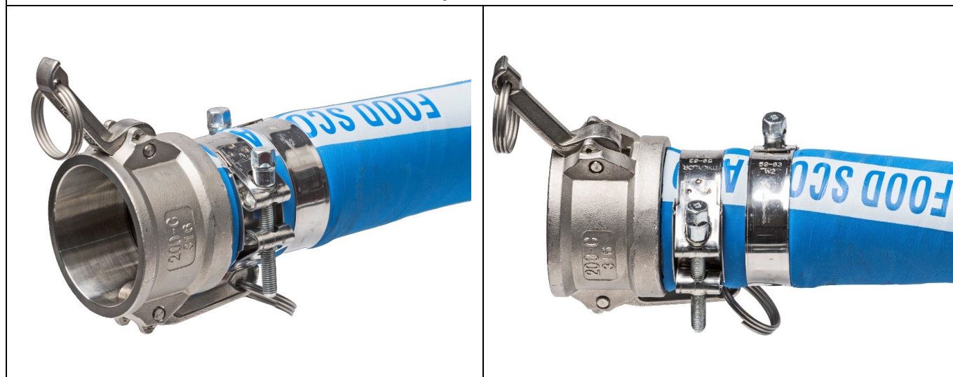
Złącze CAMLOCK typ C 2" ze stali nierdzewnej AISI 316 zamontowane do węża SCOTLAND NR DN51 za pomocą dwóch obejm SUPRA HEAVY DUTY W2
